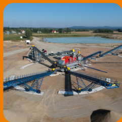
UPO – mobilny zakład przesiewający odwadniający, który podąża za złożem
